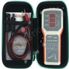
اسم الجهاز : SOLAR PANEL MULTIMETER
